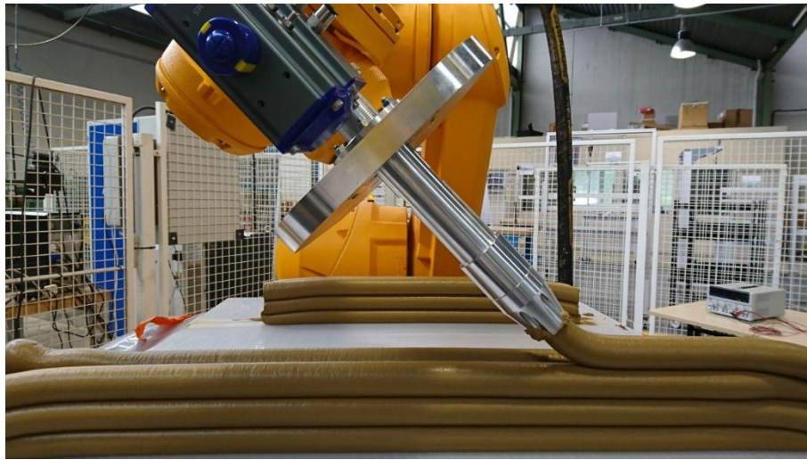
Fig. 1. Impression de matériau terre.
