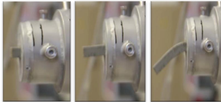
Fig. 1. Suivi de la déformation d'une couche en porte-à-faux.
