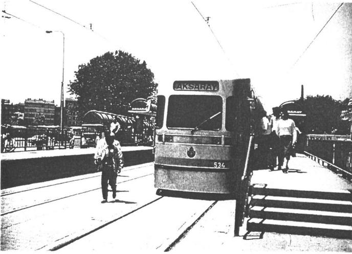
Fig. 13. «L'utilisation de ce matériel conçu pour un tout autre usage a nécessité la construction de quais hauts, peu pratiques dans une rue piétonne en centre ville (photo E. Fouache).
