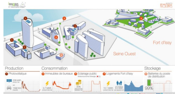
Application de visualisation des données de production et de consommation développée par EMBIX pour IssyGrid (source : Issy Grid, 2016)
