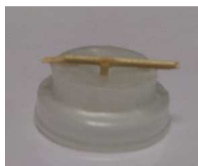
Fig. 1 : Eprouvette pour tests d'imbibition d'eau
