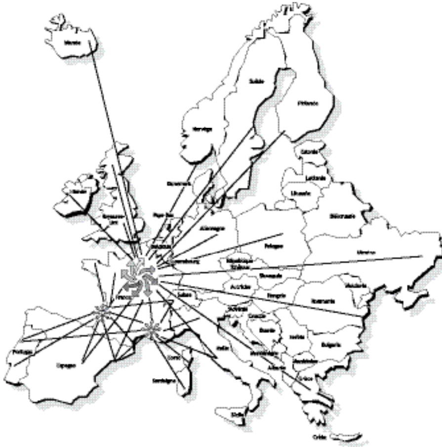
Figure 4 : Principe d'agencement d'une étoile principale et d'étoiles secondaires ou régionales
