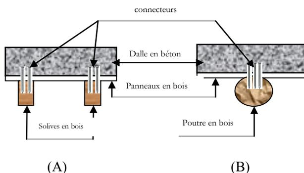
FIG. 2 – Liaisons ponctuelles des planchers mixtes bois-béton.
