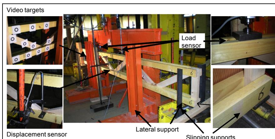
Le protocole expérimental est basé sur la norme relative aux essais de flexion des poutres en bois [3]. Pendant les essais, le protocole de chargement suivant est respecté : préchargement de la poutre jusqu'à 4 kN, correspondant à 30% de la charge de rupture  $F_{max}$  (10 kN pour faisceau 8) ; ensuite, maintien de la charge constante pendant une demi-minute, puis le déchargement jusqu'à 1 kN (2kN pour certaines poutres) ; enfin, rechargement jusqu'à la rupture total de la poutre.
