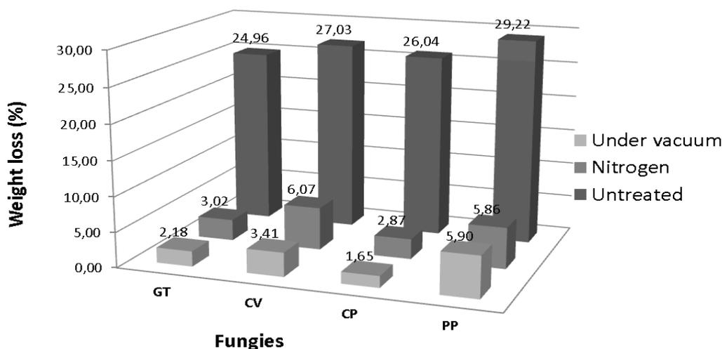
Fig.2. Corrélation entre perte de masse (WL%) due à l'attaque fongique, le type de traitement utilisé (ML=12%) et les différents types de pourritures.
