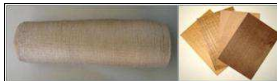
Figure 3: Renforts naturels: Fibres long unidirectionnelle continues en lin (à gauche) et placage en bois (à droite)
