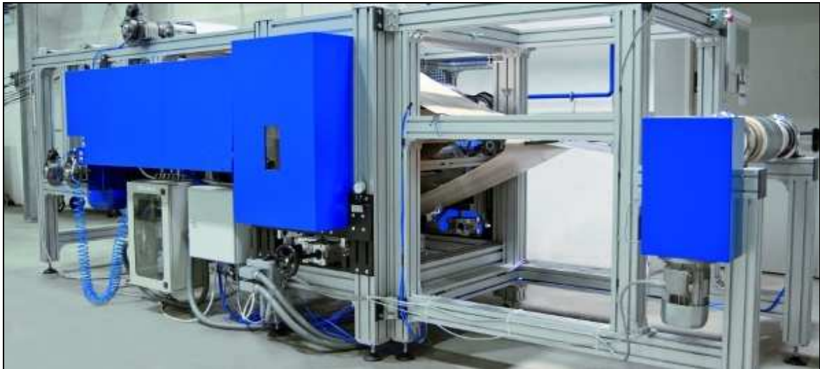
Figure 6: image de l'installation de Cetex® pour la production de prepregs
