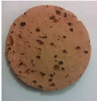
Figure 1 : Échantillon en terre cuite mélangé avec des billes de polystyrène.
