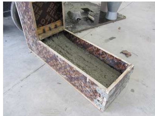
Figure 5 : Test du blocage à la boîte L
