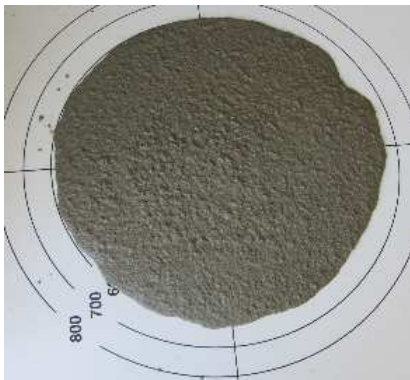
Figure 4 : Test d'étalement au cône d'Abrams.
