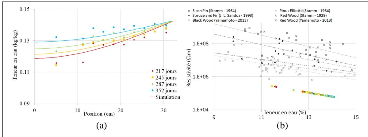
Fig. 3 : (a) Profils spatiaux de teneur en eau numériques et expérimentaux (résistivité)
