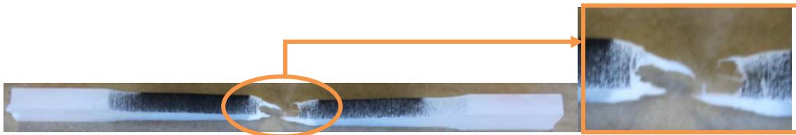
Figure 3 : Etirement d'une éprouvette de 10BS.
