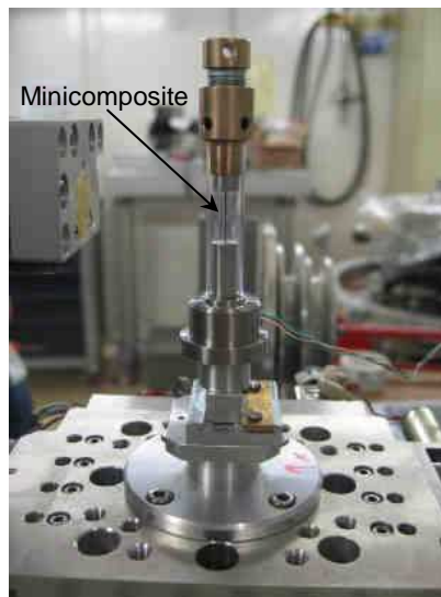
Figure 9 : Machine de traction in-situ utilisée sur la ligne ID19
